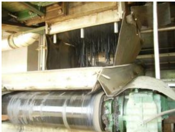
„Nudelmaschine“ zur Beschickung des Bandtrockners
